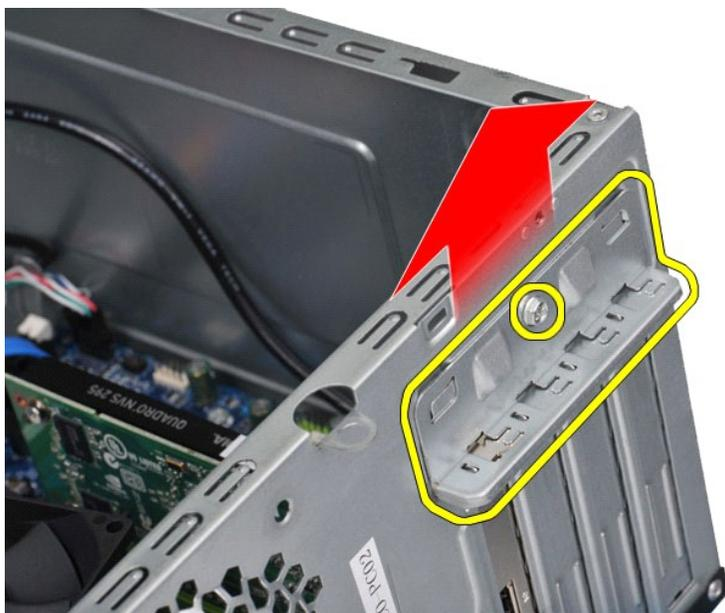
5. 要卸下 PCI-Express x16 视频卡，握住卡的顶部边角的同时，按下系统板连接器上的固定卡舌，然后轻轻地将其从连接器中取出。
