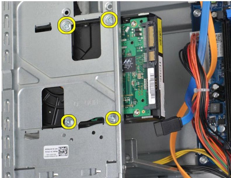
6. 向计算机背面滑动硬盘驱动器，以便将硬盘驱动器从硬盘驱动器托架中取出。
