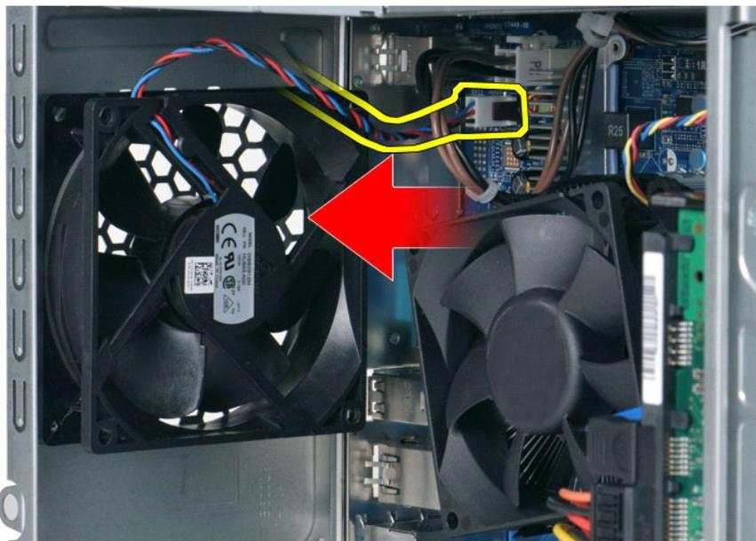
4. 握住机箱风扇，同时卸下用于将风扇固定到机箱的两颗螺钉。
