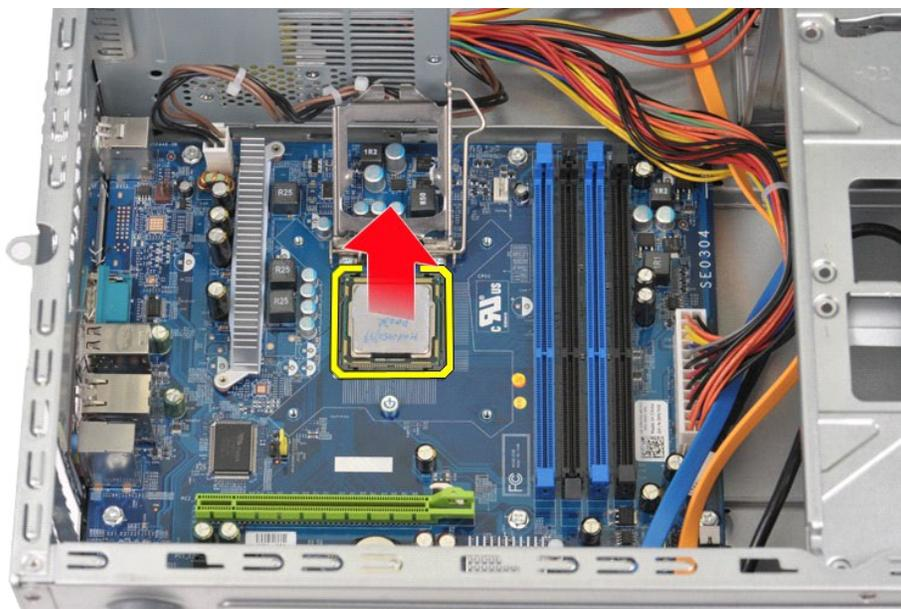
使释放拉杆保持展开状态，处于释放位置，这样可以随时将处理器装入插槽。
