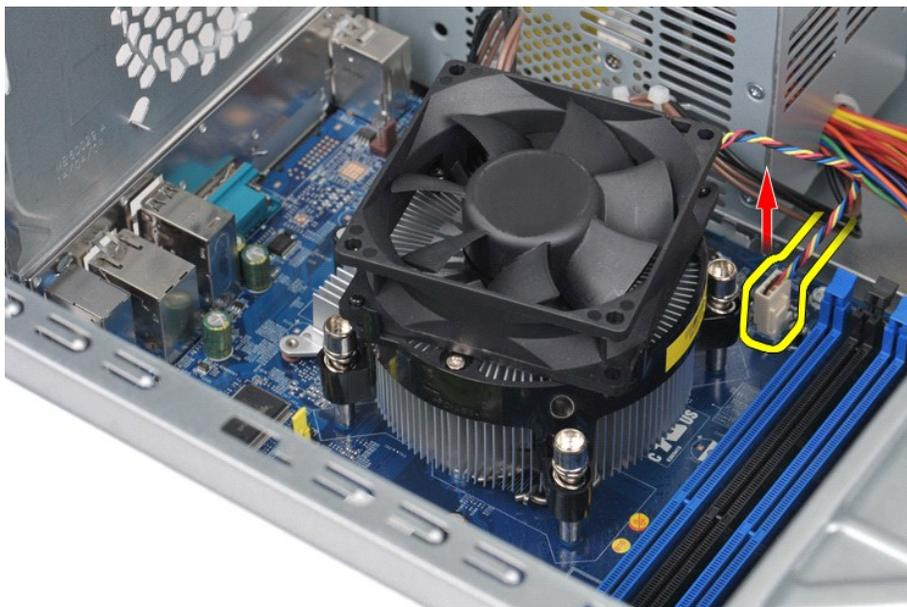
4. 使用十字头螺丝刀，拧开用于将处理器散热器和风扇部件固定在系统板上的四颗固定螺钉。
