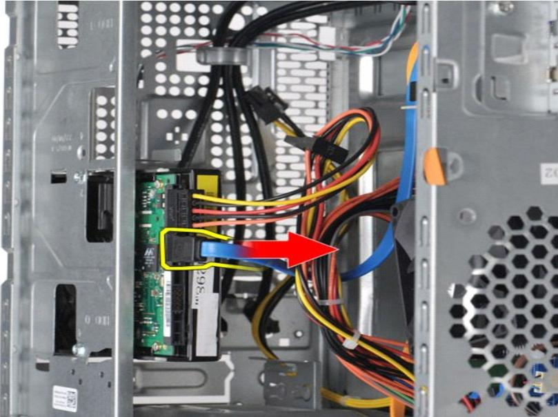
4. 断开硬盘驱动器背面的电源电缆的连接。
