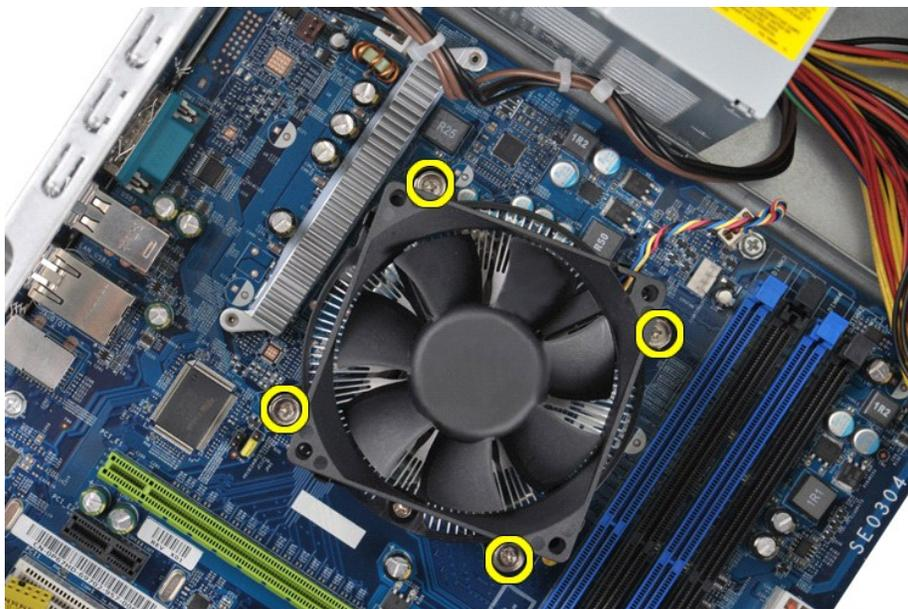
5. 从计算机中提起散热器和风扇部件，将其放在一边，保持有导热油脂的一面朝上。
