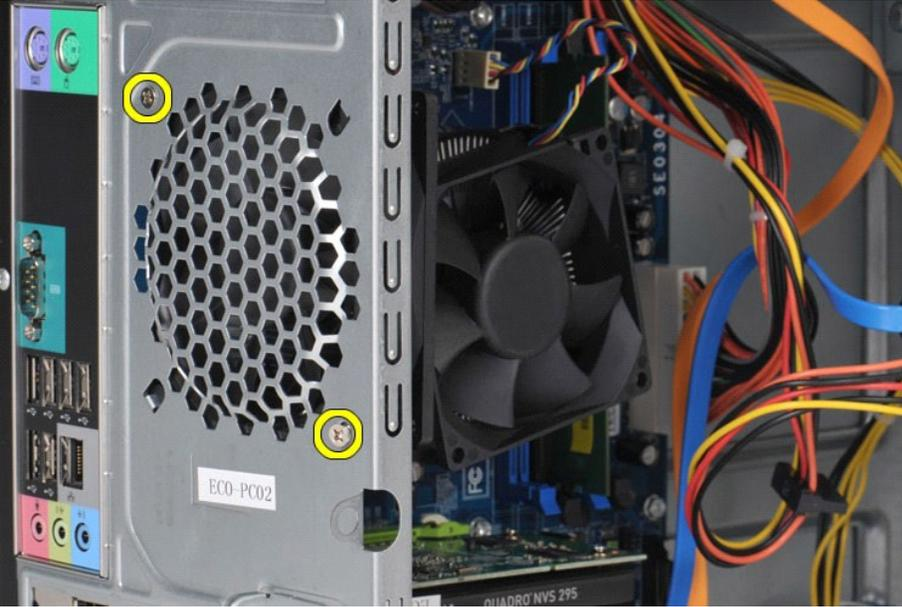
5. 将风扇向计算机中心方向移动，然后将其从机箱中提出。
