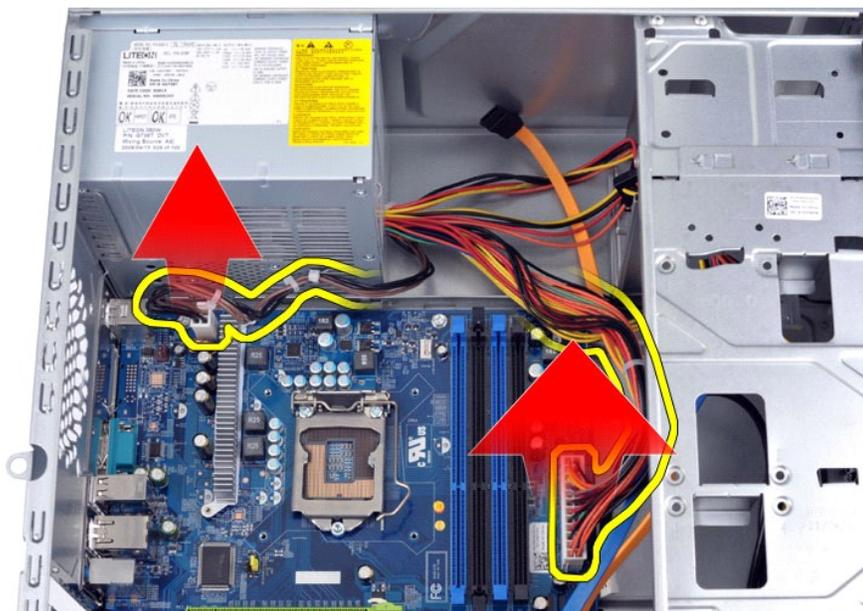
4. 将电缆从机箱电缆固定夹（如果有）中解出。
