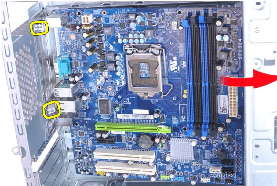
**⚠ 警告：** 装回系统板时，将系统板滑动到金属卡舌下。按压系统板（当放置在金属卡舌上时）可能会损坏系统板。
