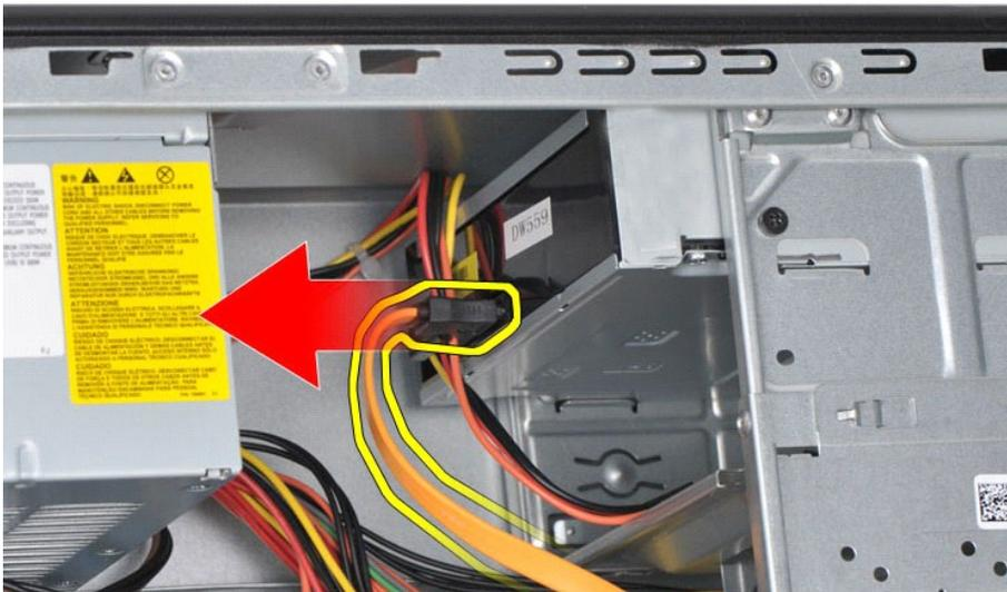
5. 断开光盘驱动器后部电源电缆的连接。
