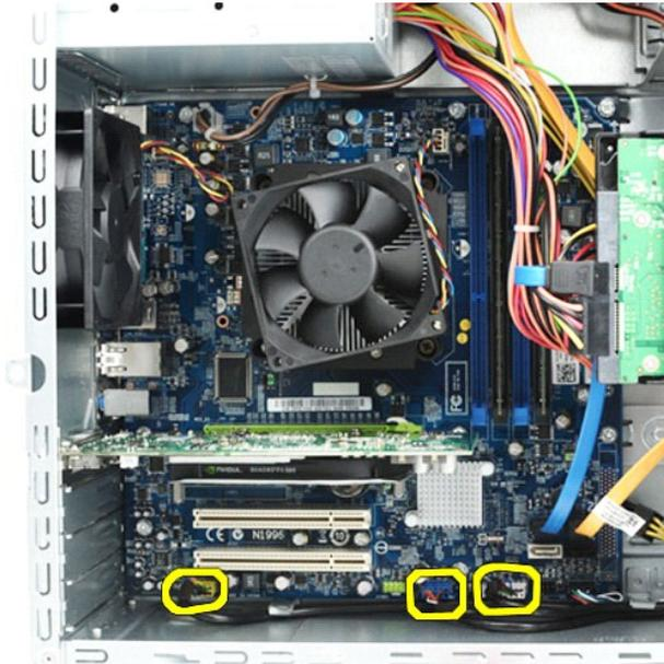
5. 将电缆从机箱内部的电缆导向器中卸下。
