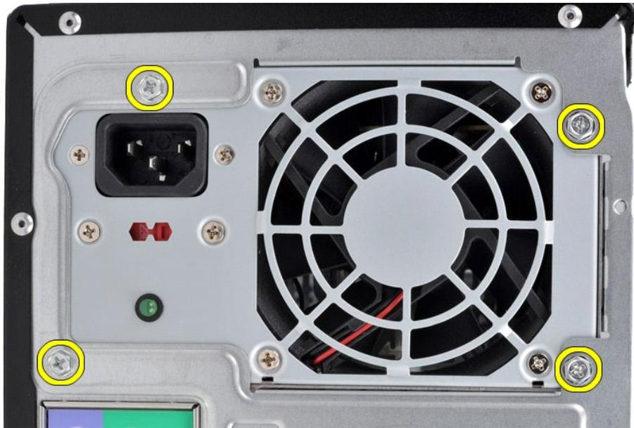
6. 按下电源设备旁边的释放卡舌，然后朝计算机的正面滑动电源设备。
