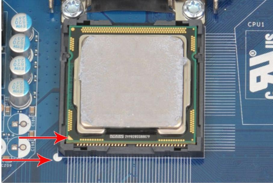
2. 将处理器轻轻放入插槽，并确保处理器与插槽对齐。正确放置处理器后，轻轻按压使其就位。
